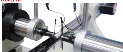
Додаткові аксесуари 3-дротовий діаметр різьби (для вимірювання зовнішньої різьби)
