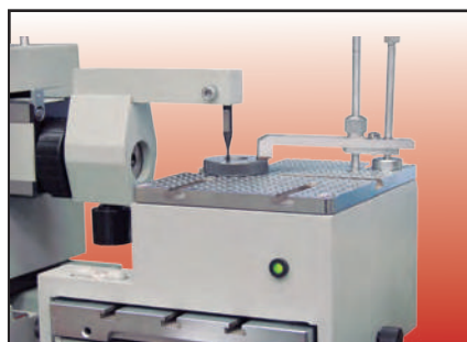
Калібрування кільцевого калібру малого розміру за допомогою пристрою «чарівне око»
