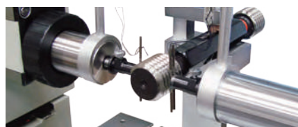
Додаткові аксесуари 3-дротовий діаметр різьби (для вимірювання зовнішньої різьби)
