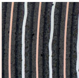
Деталізація компонентів літій-іонної батареї
